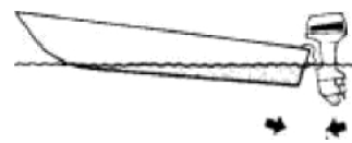
PREA MIC UNGHI DE ÎNCLINARE (pruva prea ridicată)
